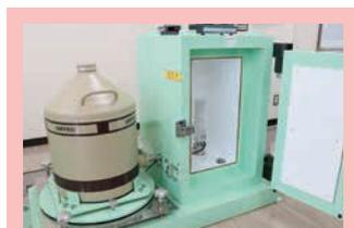
灰化した試料を約1日かけて測定し、放射能の濃度を求めます
