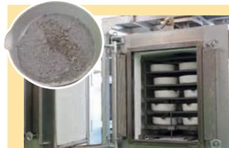
105℃で1日以上乾燥させた後、450℃で1日中加熱し灰にします
